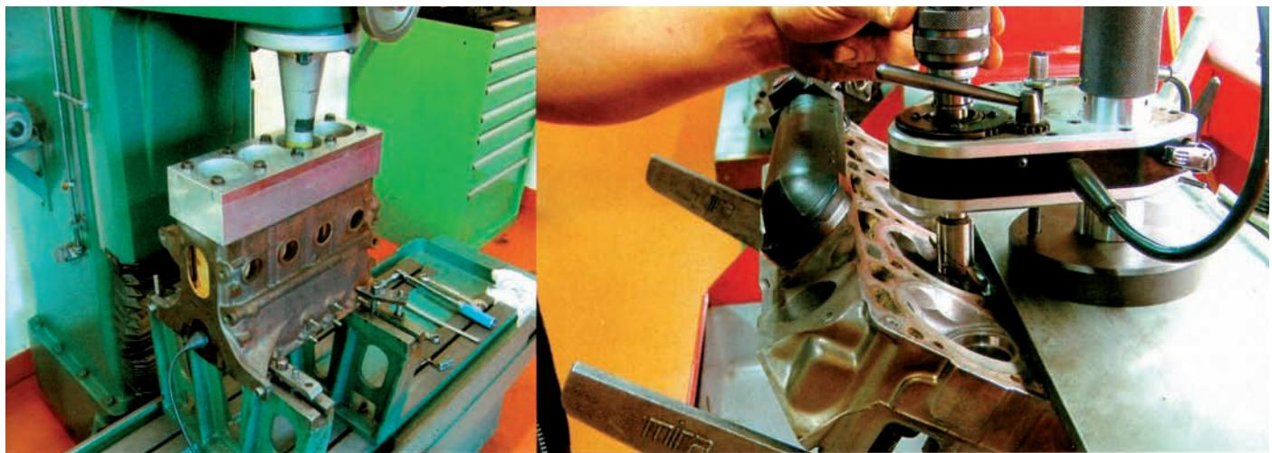
Die Grundbohrungen für neue Ventilsitzringe werden vorbereitet. Es werden neu Stahlsitzringe eingesetzt, die den Betrieb mit Bleifrei-Benzin erlauben.
